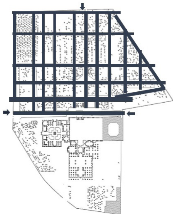
تصویر ۱۱: بازسازی تصویری پلان مجموعه شیخ احمد با توجه به موقعیت محورهای اصلی و ورودی‌های موجود و نظم گیاهی محسوس. مأخذ: دفتر فنی میراث استان خراسان رضوی، بازطراحی شده توسط نگارندگان.
