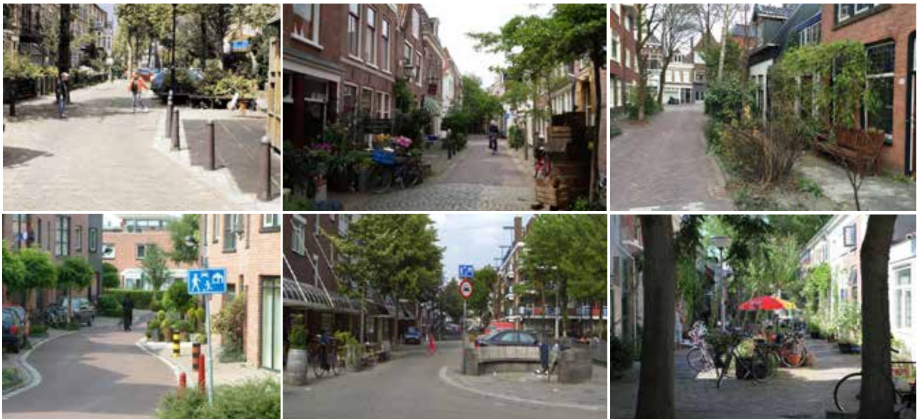
تصاویر ۲-۷: اولویت مسیر پیاده، دوچرخه و فضای بازی کودکان، مارپیچ کردن معابر و جانمایی مبلمان و فضای سبز محوطه در وونرف اولیه، دلف، هلند. مأخذ: www.feedyeti.com/woonerven
