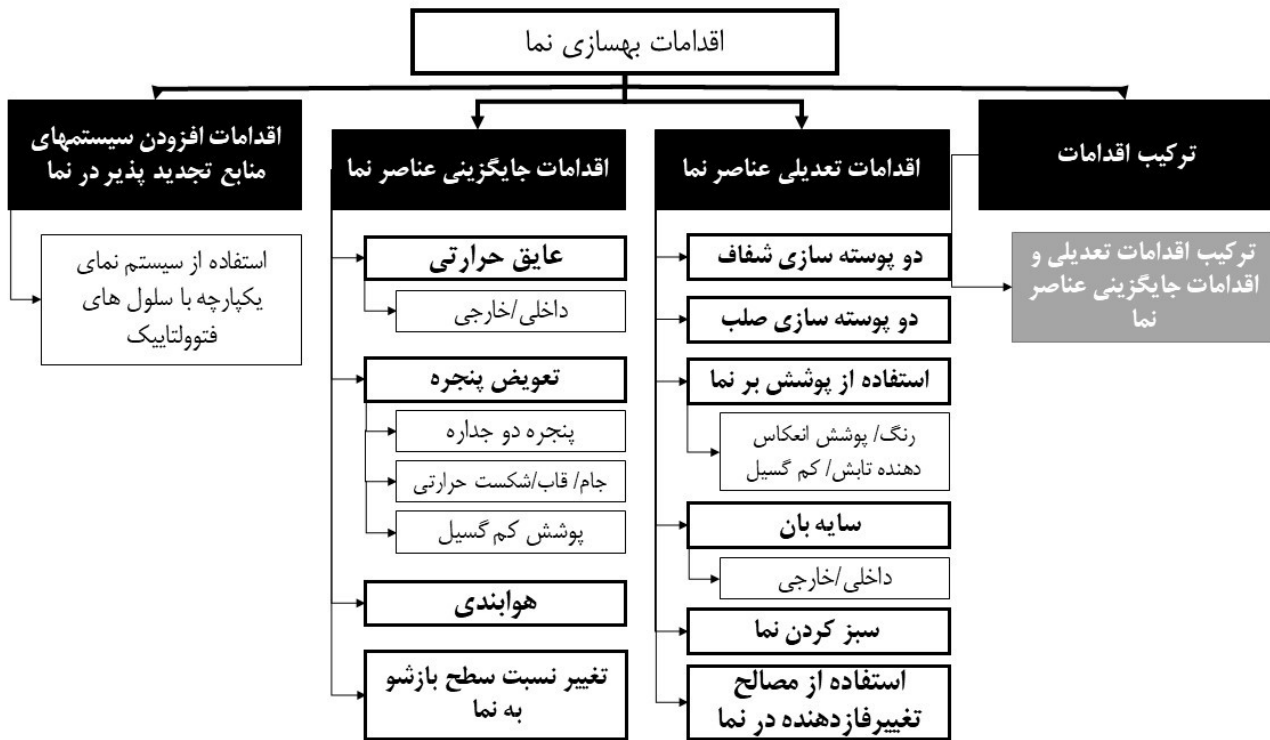
تصویر ۱. اقدامات بهسازی نما جهت کاهش مصرف انرژی در ساختمان‌های موجود. مأخذ: Sarihi et al., 2021
